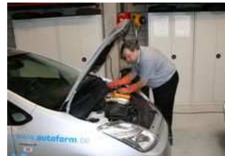
Mit den notwendigen Elektriker-Handschuhen ausgerüstet, überprüft Gino Decoster die Spannung eines Hybridfahrzeugs.
